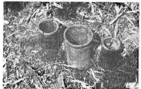
写真1. スギハムシ幼虫調査用円筒型土壤堀取器
