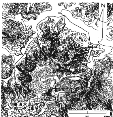
図-2 鉄砲水による土砂氾濫位置と湧水点
