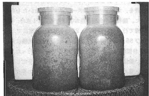
写真2 T. harzianum 胞子3個を接種したときのヒラタケ菌床の様子 (培養20日後) 注：ヒラタケの菌糸は観察されなかった。
