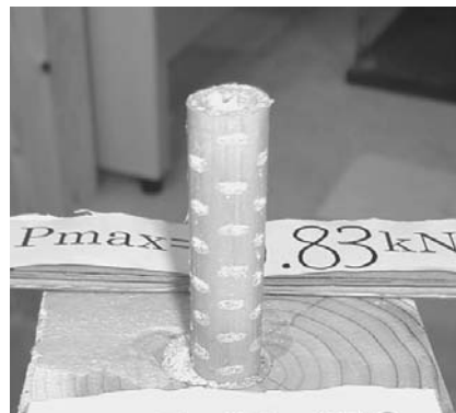
写真－9. Uシリーズ破壊性状
