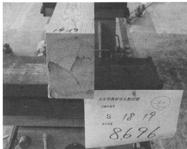
写真-4. 内部割れに沿ったせん断破壊の状況
