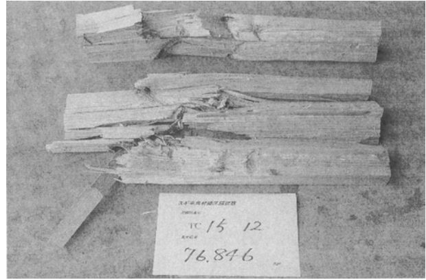
写真-2. 内部割れに沿った破壊状況 (高温乾燥材)
