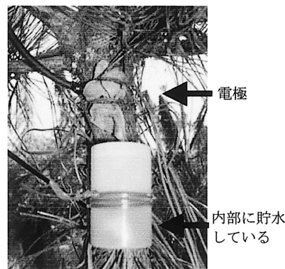
図-1. 給水装置 電極の上に固定したガーゼの一端を，円筒状のケースに入った水に浸らせたもの
