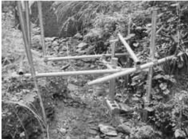
写真-1. 流路での磁歪式センサーによる水位観測
