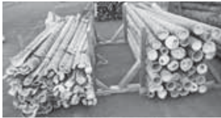
写真-4. 天然乾燥試験 (左: 割竹, 右: 丸竹)
