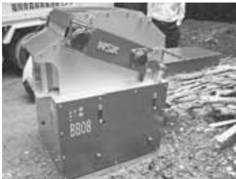
写真-1. 竹割り機の試作機
