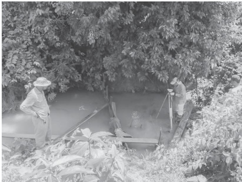
写真-1. オーテックロー流域の堆積土砂観測用簡易堰
