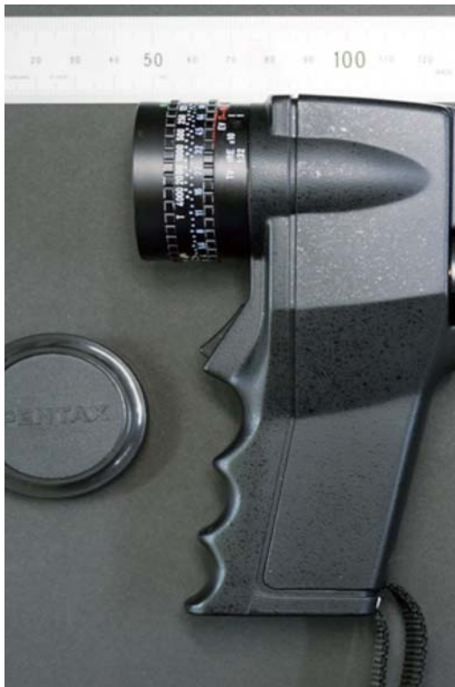
写真-1. 輝度値（EV）測定に用いた露出計（デジタルスポットメーター、ペンタックス社）
