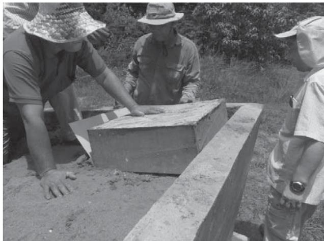
写真-1 プノンペンに設置した侵食斜面プロットに矩形土塊コアを配置する様子 (2017年5月)
