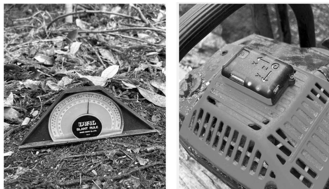
図-2. ダイヤル勾配計 (左) と慣性計測装置 (右)
