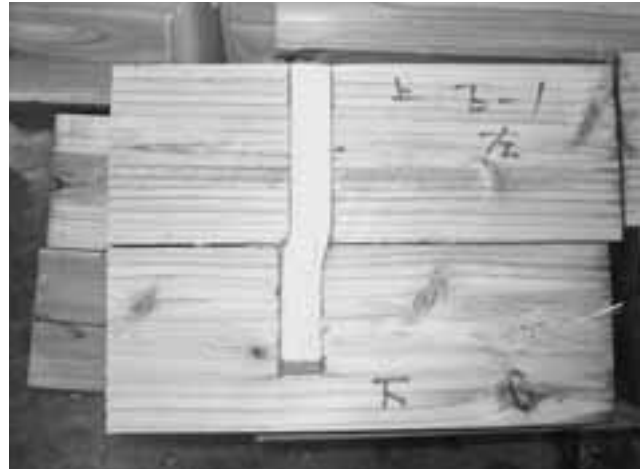
写真-4. 木ダボのせん断変形
