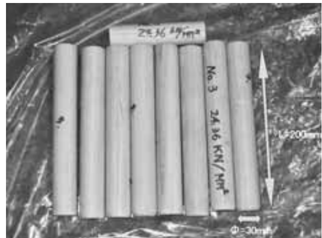
写真-2. 木ダボ (ラミン丸棒 L=200mm, φ=30mm)
