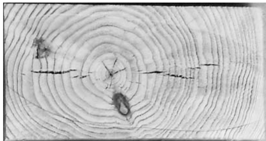
図-1. 内部割れ発生状況 (試験木番号13)
